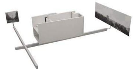
>> *Mit einem Innenraum-Modell untersuchte der Architekt die Sichtachsen und Blickperspektiven, die vom Haus aus entstehen. So können zum Beispiel Fenster genau auf besondere Ausblicke zugeschnitten werden. (Projekt\_03)*
